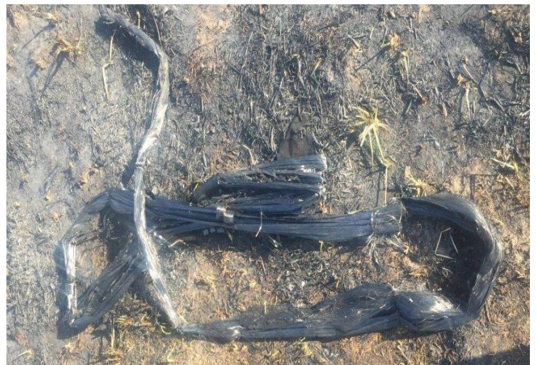
Углепластиковое удильце после прохождения электрического тока
